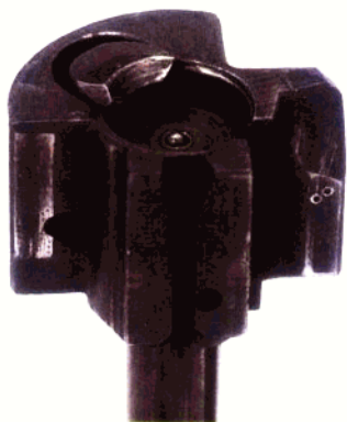
APS枪机前部，枪机的形状与AKM的几乎相同，左右侧各有一个闭锁凸笋。
