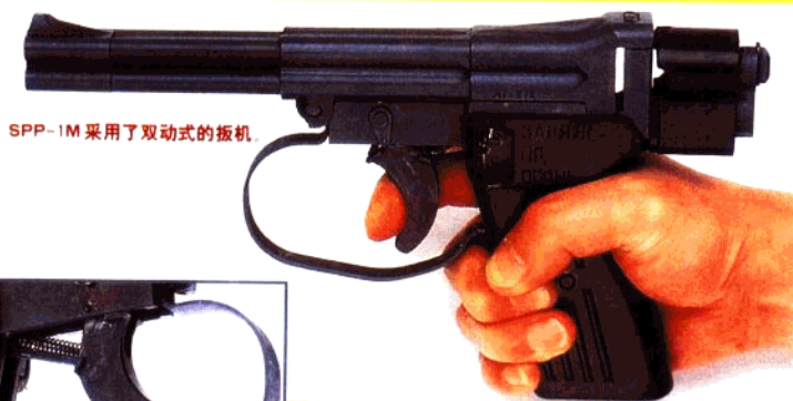
← SPP-1M 的握把是用酚醛 塑料压成的左右 两片，通过固定 螺固定在扳机座 上而形成的。
