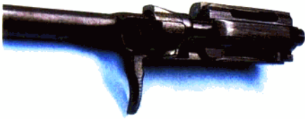
FPR 狙击步枪的枪机和枪机框，它们的外形与德拉戈诺夫狙击步枪的相同。但 FPR 的复进簧和活塞比德拉戈诺夫狙击步枪的要短一些。
