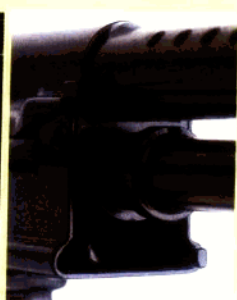
APS 机匣前端部位特写。为了能迅速放出进入枪内的水，减少枪机框受到的水压，机匣前端为开口式结构。
