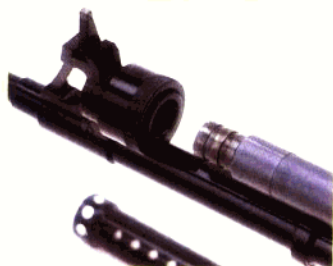
卸下活塞筒后看到的活塞和前方活塞帽部位。活塞前端的直径虽然没有多大变化，但活塞后部以增加重量为目的而加得很粗。
