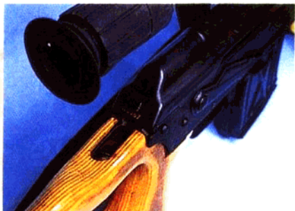
FPR 狙击步枪的机匣盖后端设有机匣盖固定卡笋，一按进这一卡笋就能打开机匣盖。
