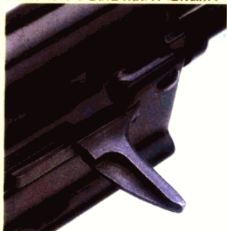
位于枪右侧的拉机柄，拉机柄与枪机框是一体，射击时随枪机框一起前后运动。
