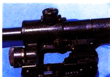
PSO-1 式瞄准镜与枪连接一侧的结构示意
