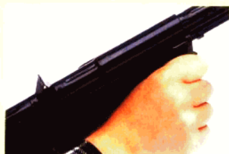
拉机柄体积虽较小，但因突出于机匣右侧，所以在水中也很容易摸到并进行操作。
