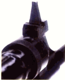
APS的准星，准星两侧没有采用护翼。在能见度很低的水中，瞄准装置是越简单越好。
