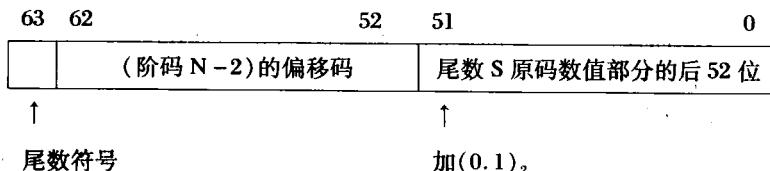
尾数 S 的二进制位数决定了所表示实型数的精度(即有效数字的位数)。在上述实型数的表示法中,尾数共有  $52+1=53$  位,即实型数精确到  $2^{-53}$ ,而
