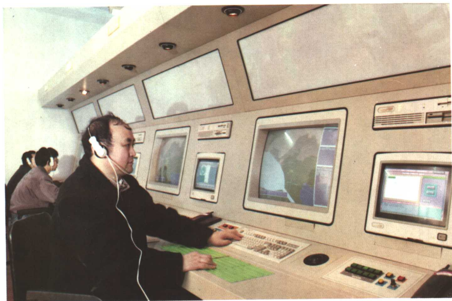
计科系游志胜教授研制的航管雷达模拟机
