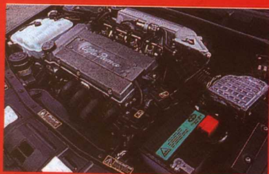
傳統的雙火星塞可產生最高 140HP / 6000r.p.m 的馬力
