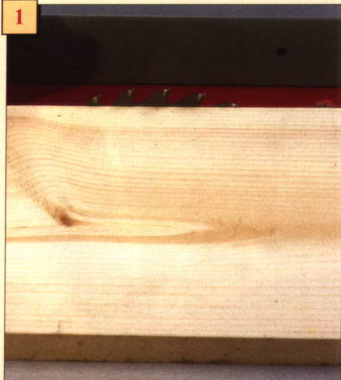
设定锯刃高度，使锯齿间距可切割至木板顶部。
