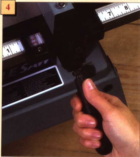
切割一定宽度的木板：正确设定护栏锯刃间距，并仔细检查。
