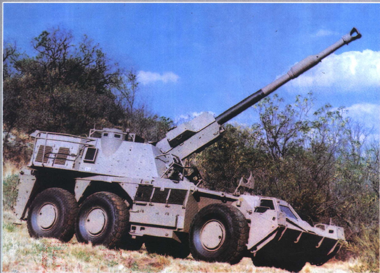
南非G6自行加农榴弹炮 是一种新式轮式自行加农榴弹炮。口径155毫米，身管长45倍口径，发射榴弹时最大射程30.8千米，发射弹底排气弹时最大射程39千米。高低射界 -5^{\circ} 至 +75^{\circ} ，方向射界360度（实际使用80度）。爆发射速3发/21秒，持续射速4发/分。精度：距离公算偏差为0.48%；方向公算偏差为0.1%。战斗全重46吨。全长（炮身朝前）10335毫米，车体长9200毫米，宽3400毫米，高（含机枪）3800毫米，通过垂直障碍高450毫米，越壕宽1300毫米，爬坡度50%，涉水深800毫米，最大公路时速90千米，最大行程600千米，配有榴弹、弹底排气榴弹、照明弹等。
