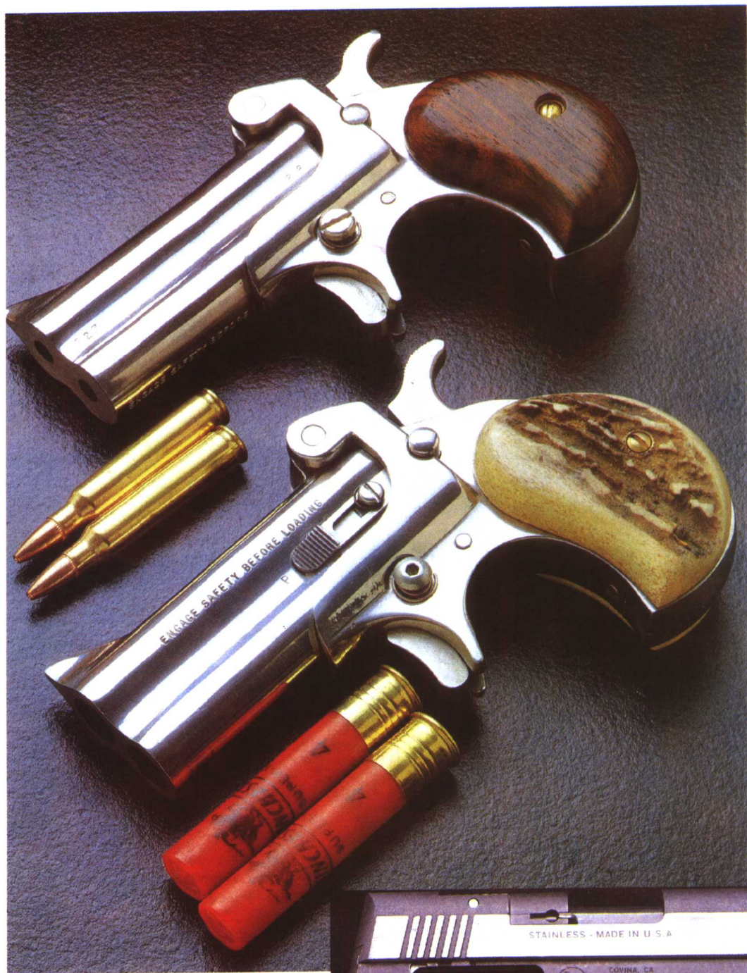
美国“德林格”袖珍手枪 这两把手枪为同型手枪，上面的一把口径5.56毫米，全长122毫米，重量485克，弹容2发；下面的一把口径6.35毫米，全长122毫米，重量445克，弹容2发。
