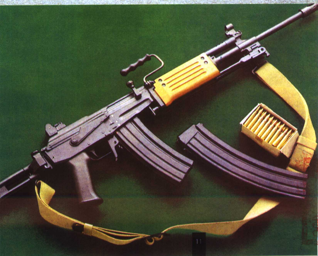
以色列“伽 利尔”突击步枪 口径 5.56 毫米， 全长 740 / 970 毫 米，重量 3.9 千 克，弹容 35 ~ 50 发。
