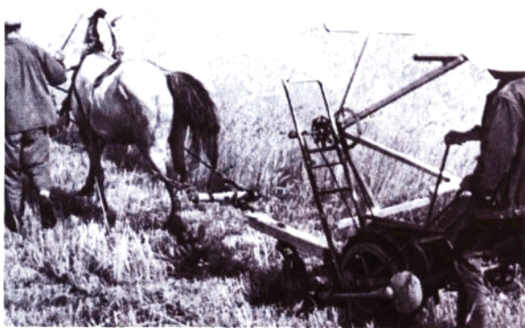
试验成功的“太谷式”畜力小麦收割机，一天可以收割30亩，1960年将进行推广
