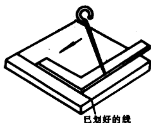
图 2-11 用直角尺划垂直线
