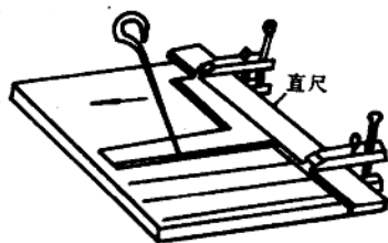
图 2-10 用角尺和直尺配合划平行线
