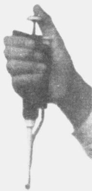
图 2-2 吸液操作示意图
