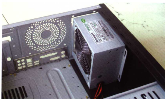
图 1-21 将电源放到安装位，电源标签面朝上，含有吸风风扇的一侧朝向主板
