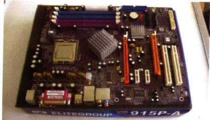
图 1-31 将主板放在安装台上
