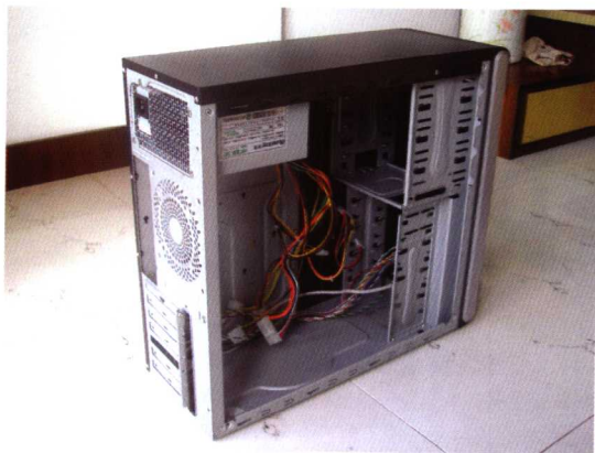
图 1-23 安装好的电源全貌
