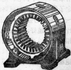
图1-4 定子铁心装在机座内腔中
