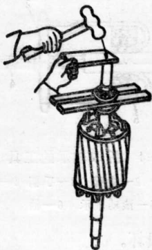
图2-5 用铁板木凳支撑敲打 轴端拆卸轴承的方法
