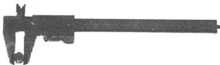
图1-6 游标卡尺,用于测量外径和内径
