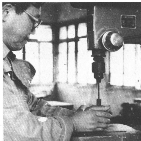
机器装小修光刀刀柄（刀柄一端先钻孔）
