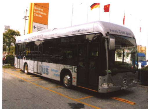
图11 载姆勒-克莱斯勒公司生产的燃料电池公共汽车
