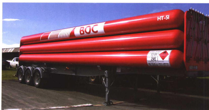
图7 地面加氢站用(移动式)35MPa储氢罐
