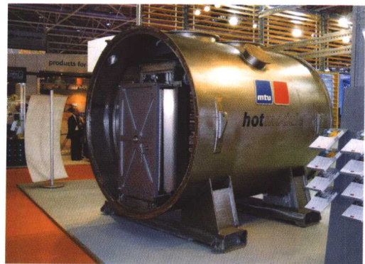
图15 在德国汉诺威工业博览会上3MTU公司展示的250kW的MCFC电站
