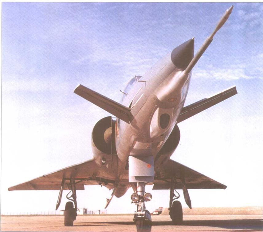
←以色列曾计划通过“米兰”计划与瑞士合作改善“幻影”5的低速操纵性和在野战机场的短矩起降性能。虽然最终并没有根据这个计划制造出生产型飞机，但是实验过程中飞行性能的成功提升使得以色列决定在其研制的“幼狮”飞机上安装鸭式前翼。
