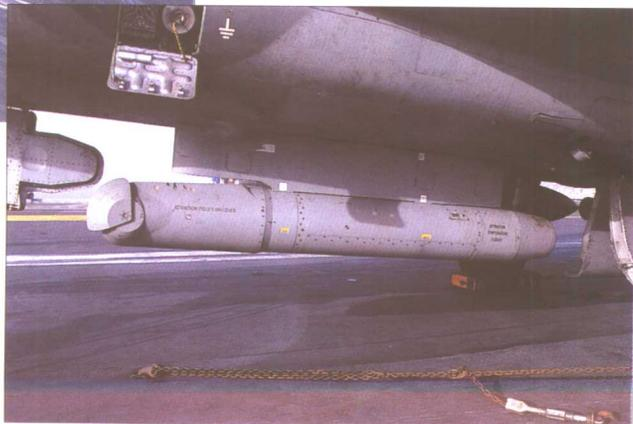
↑ 在第12机群的F-8P“十字军战士”型飞机于1999年12月退役以后，第16机群的“军旗”IVPM和第6机群的“信风”式飞机也于2000年相继退役。在此之后“超级军旗”攻击机就成为了“老”一代海空军用飞机的最后一个幸存者。但该飞机还将与诺斯鲁普·格鲁门公司的“鹰眼”和达索公司的“阵风”M战机一起服役到21世纪的最初10年。它将和“新”一代的海空军用飞机并存使用。这幅照片拍摄于F-8P“十字军战士”最后的某一次巡航过程。图中的这架标准3型飞机携带了一个ATLIS II 瞄准吊舱。
