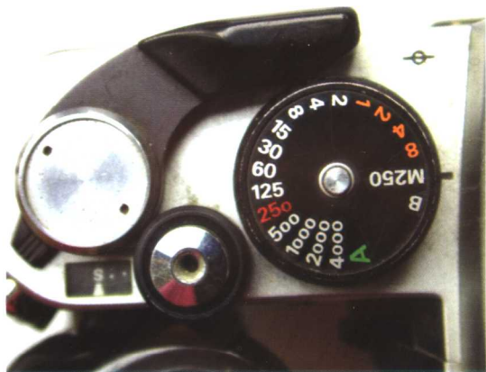
图8 速度调节盘上的快门系数
