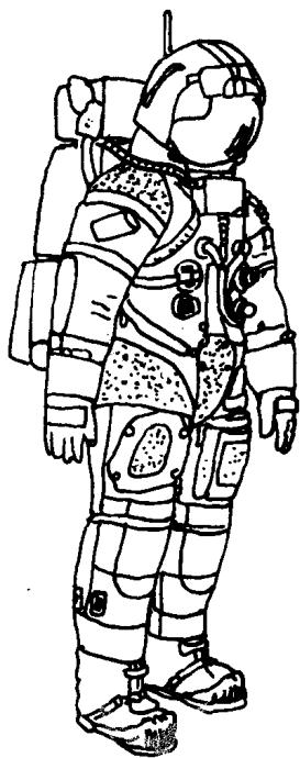
内衣，所以内衣是用质地柔软、吸湿性和透气性良好的优质棉针织品制作的。第 2 层是保暖层。它是用保暖性好、热阻大、柔软、质轻的材料，如超细高保暖合成纤维、羊毛制成的，用以保持舒适的温度环境。第 3 层是通风服和水冷服。用以散发宇航员过高的体热。当人体产热量过大，凭通风服散热，仍不能满足散热要求时，即由水冷服降温。第 4 层是气密限制层。宇航员在航天过程中，是在真空环境中生活的，没有空气压力，宇航员便不能生存。气密限制层可以保持宇航员身体周围有一定压力。气密层用气密性好的涂氯丁尼龙胶布等材料制成，此限制层选用强度高、伸长率低的织物制成，如涤纶织物等。第 5 层为隔热层。它是用多层镀铝的聚酰亚胺薄膜或聚酯薄膜制作的，在各层之间夹有非织造布作衬垫。它在宇航员于舱外活动时在过热或过冷的外界条件下起保护作用。第 6 层是外罩保护层。它是宇
