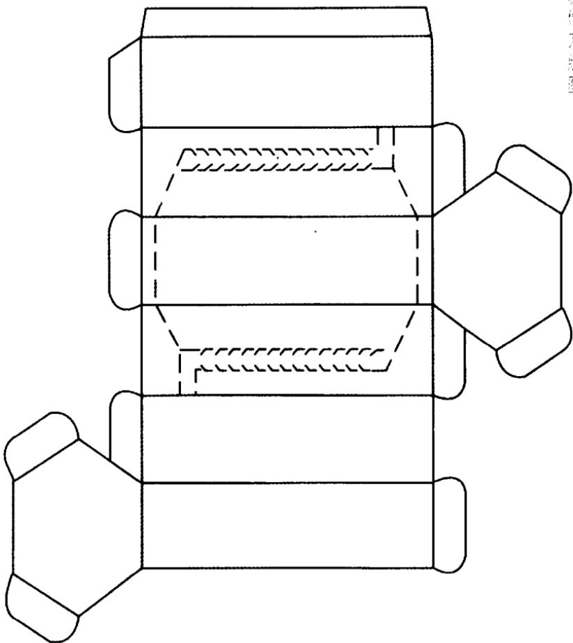
这款是保护内装物品的筒装纸盒。包装品大多为灯泡等。由于物品易损坏，因此采取这种以保护为主体的设计方案，以处理玻璃球面和金属部分为中心，将球面的接点和金属的螺丝部分固定起来，并在外面附加盖子和底部加强保护。
