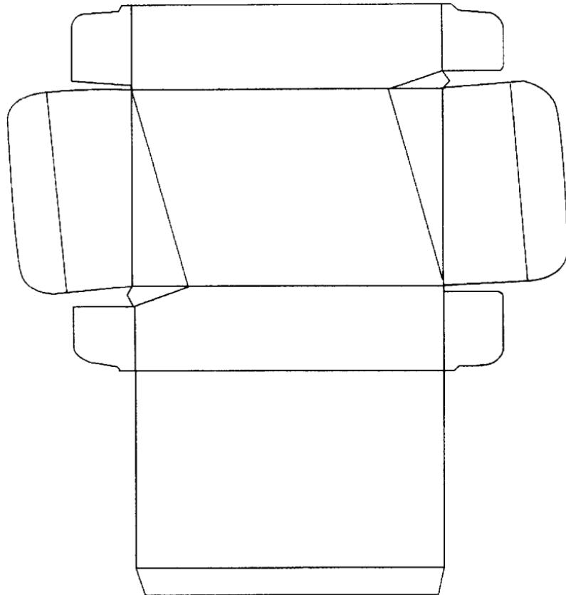
这款是顶部左右两侧为斜面的筒状包装。该设计具有礼品包装盒的特点，同时为了使顾客能够看见包装品的材质和颜色，在顶部设有一个小窗。由于采用了倾斜面的设计，使得盒子看起来有一定的变化，感觉良好。在设计这个产品时，将盒子的形状放在首位，在构造上采用插入式的处理方法，打开关闭都十分简便。
