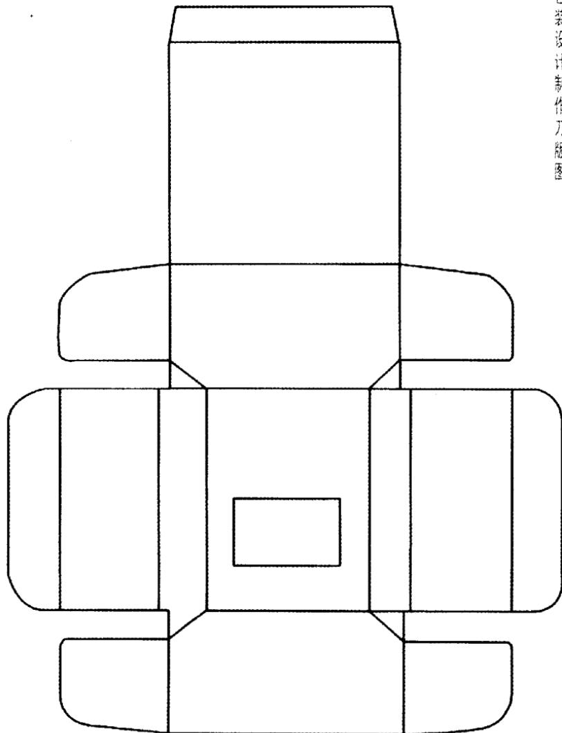
这款是顶部前后两端有斜面的筒状包装。设计虽然比较简单，但将对角稍稍下降的处理使得整体的感观发生了很大的变化。在形状设计上，增加了柔美的设计，从而增加了高级感。在构造上采用插入式的处理方法，打开关闭十分简单。
