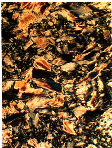
38.四川广汉三星堆遗址出土玉器正交偏光 10 × 3.2 倍晶体结构显微照相 (苏永江)
