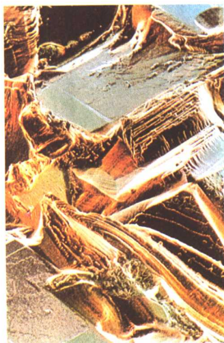
电子显微镜放大一百倍的海盐晶体。电子显微镜直到30年代才诞生。它能够把比人的肉眼可见物小一百万倍的东西放大成像。
