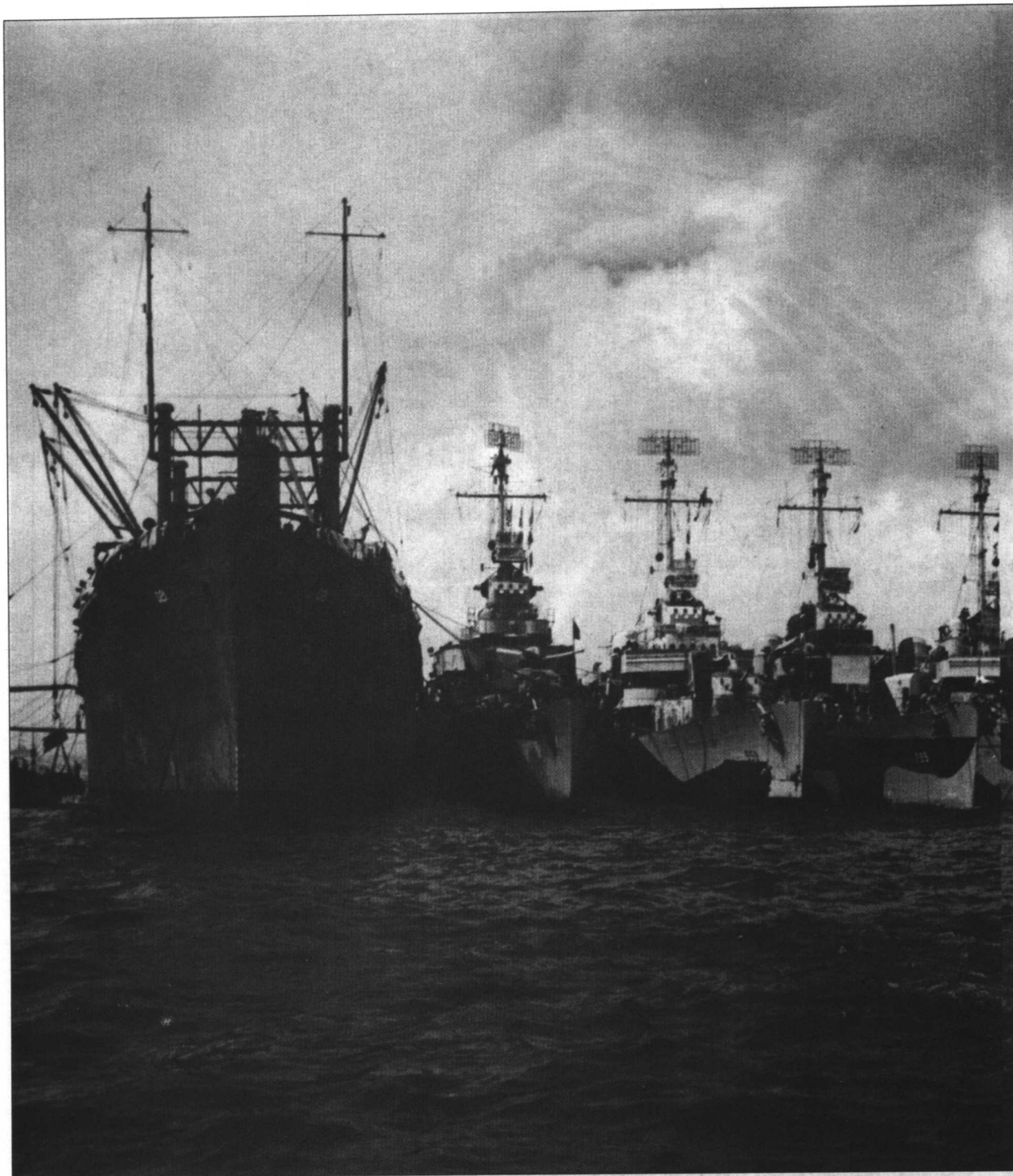
一排驱逐舰通过跳板连接在一起，它们可以从左面较大的补给船（一个流动的工场，里面装满了工具和供给）的技师那里获得维护。
