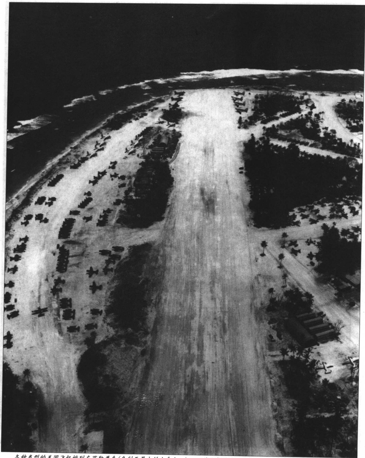
各种类型的美国飞机排列在菲勒普岛(乌利西最大的小島之一)3500英尺长的飞机跑道上。海军修建营把日本人修建的粗糙的飞机跑道扩大了。
