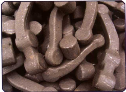
图2.11 经模锻后的汽车零件毛坯
