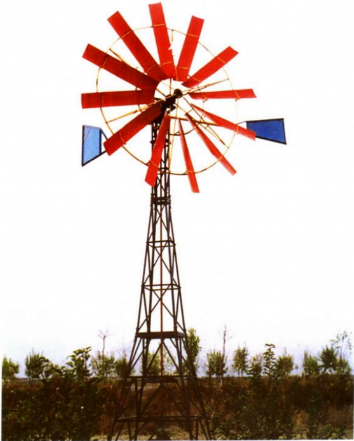
风力提水机组在农村使用
