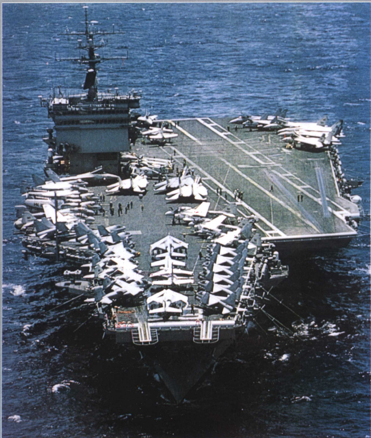
美国“企业”级“企业”号航空母舰 是世界上第一艘核动力航空母舰。满载排水量90970吨，舰长331.6米，舰宽40.5米，舰高11.9米，飞行甲板为331.6×76.8米，航速34节，编制人数3319人。搭载90架各类飞机，另有3座MK-57八联装“海麻雀”防空导弹发射装置，3门MK-16“密集阵”近距离武器系统，3门MK-68型20毫米炮。已3次更换燃料，累计航程50万千米。相当于绕地球航行23圈。
