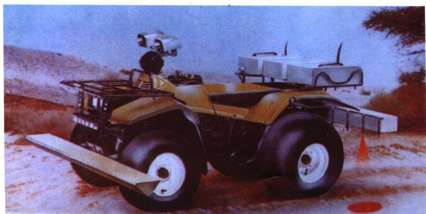
↓ 可扫地下 30 厘米深非金属雷的美国遥控扫雷车
