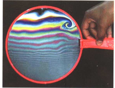
彩图 3 肥皂膜白光下的等厚干涉图样
