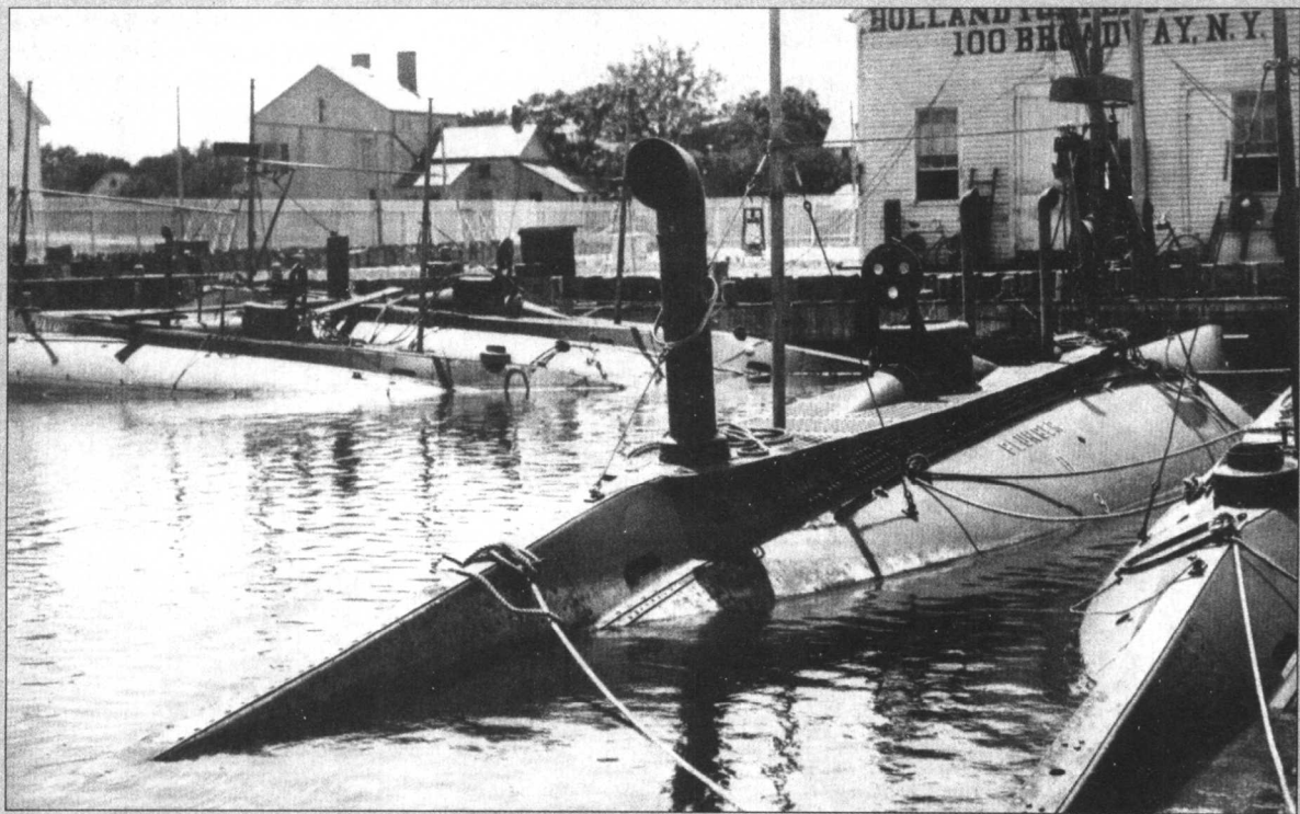
1902年,霍兰德鱼雷艇公司制造的5艘潜艇停泊在纽约的一个港口。“潜水者”号潜艇(中部)是“霍兰德”号的改进版,排水量高达120吨,运载5枚鱼雷,由160马力的汽油发动机驱动。
