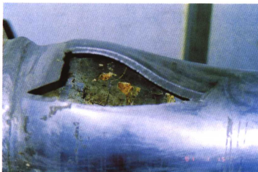
图3 厚壁容器韧性断裂外观
