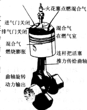
图 2-4 发动机动力的产生
