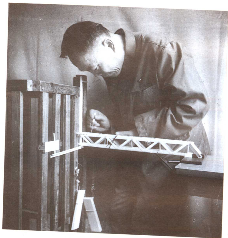
1970年—1971年在隔离劳动期间 在家里做桁梁桥扭转力学模型试验
