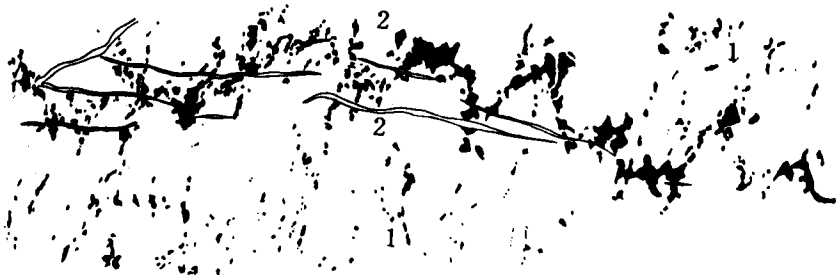
图5 11号矿群标本素描 (示裂隙吸收矿液现象。黑点为铬矿颗粒)
