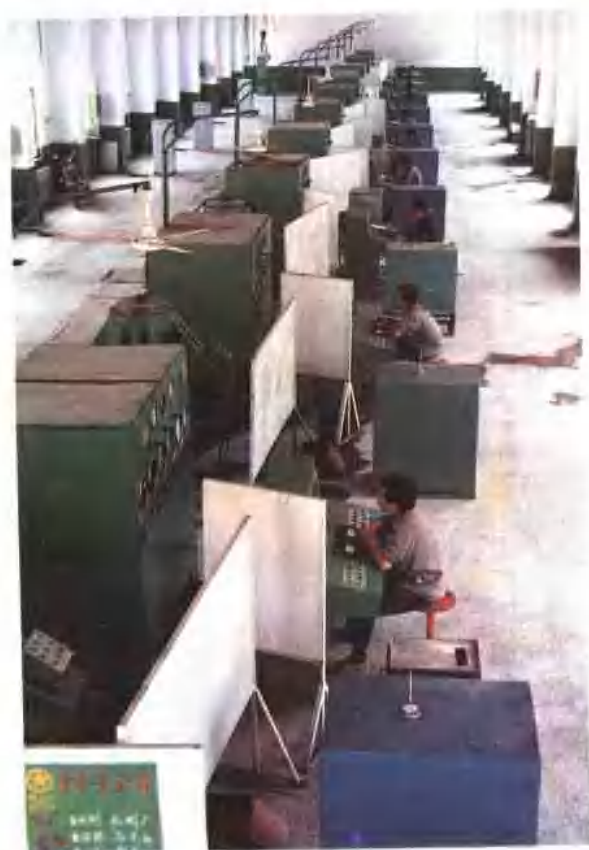
人造金刚石生产线
