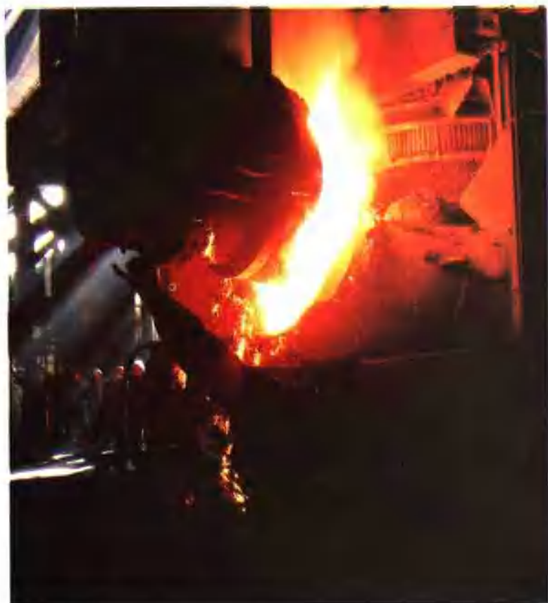
新建3号25吨氧气 顶吹转炉在兑铁。
