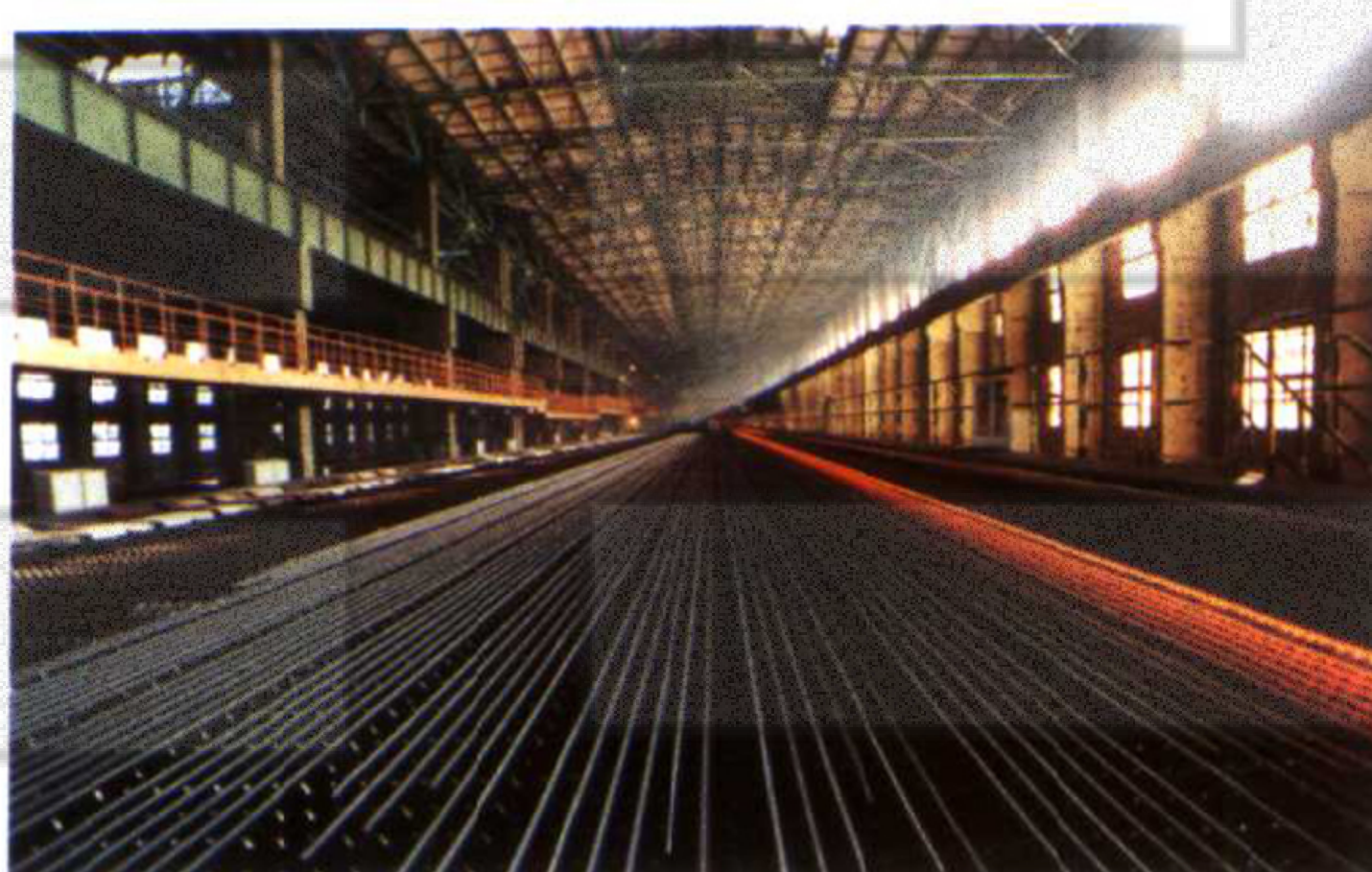
▲ 从国外引进的具有当今国际先进水平的棒材轧机生产线
