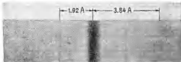
图10 Pb I 2873.316 Å与罗兰鬼线的图象 (600条缝/毫米光栅，Ⅰ级)
