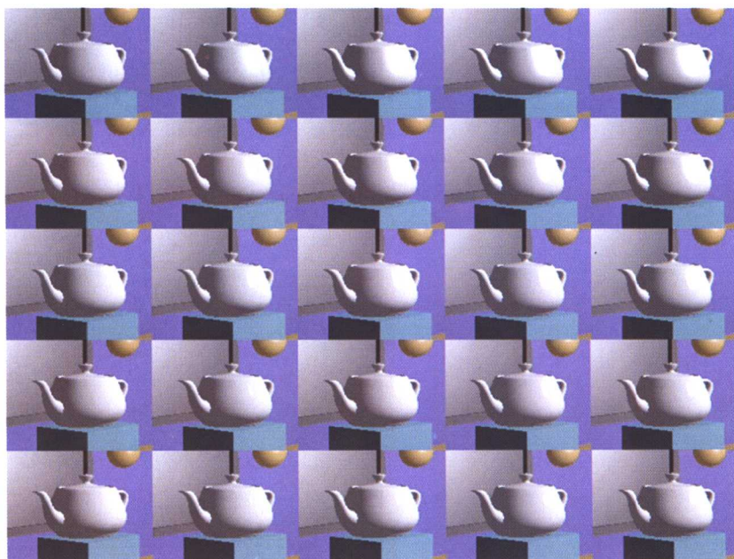
图 6-28 描述 Phong 明暗模型的“传统”方式。 K_s 和 K_d 是常量，在整个过程中 K_s 从左到右递增，指数从上到下递增。模型的光泽度通过增大指数而提高，使得镜面高光区域更小。这也可以解释为大小变化的光源的反射度（这里使用点光源）
