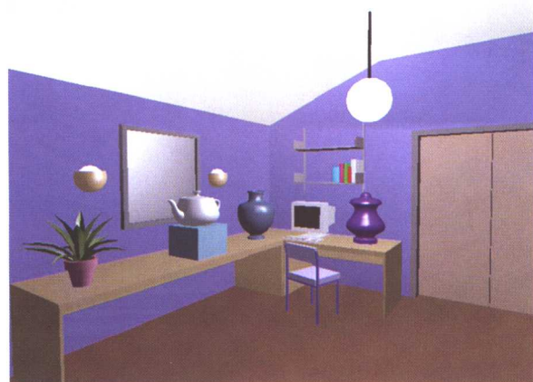
图 6-38 Gouraud 插值的主要缺点。a) 彩图。该图像(在文中有详细介绍)的两个缺点为：后墙上的马赫带效应(重新生成后可能会看不到)和插值赝象
