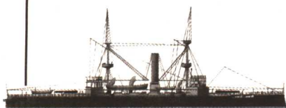
英国的早期铁甲舰，还没有配备旋转炮塔。
