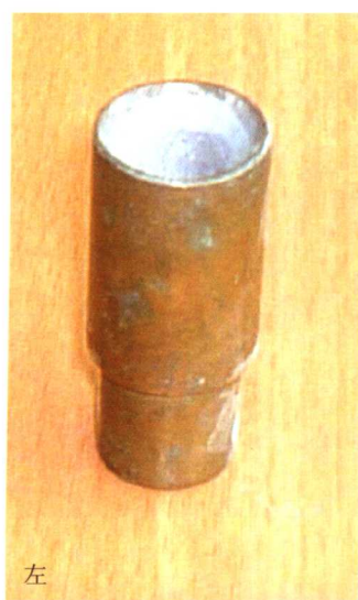
彩图 3-40 钻石头 左：V形圆锥头 右：凸形头
