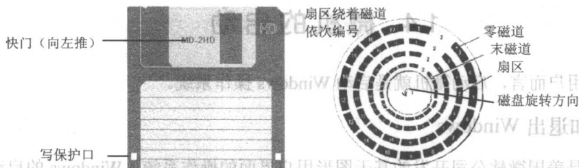
图 1-4 3.5 英寸软盘的外形图、磁盘的磁道和扇区
