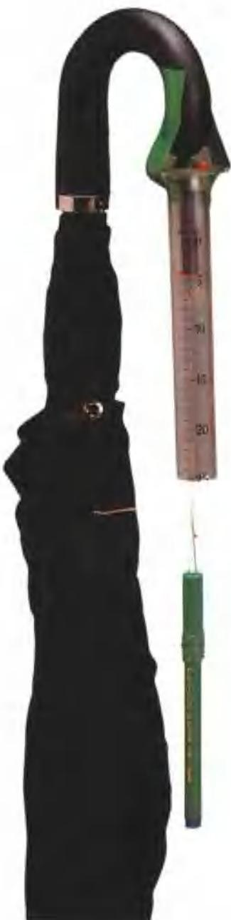
2 将雨伞牢牢立在电梯地面上，然后观察测力计的刻度。电梯启动上升后，物体的重量会因惯性的缘故而增加。当电梯
