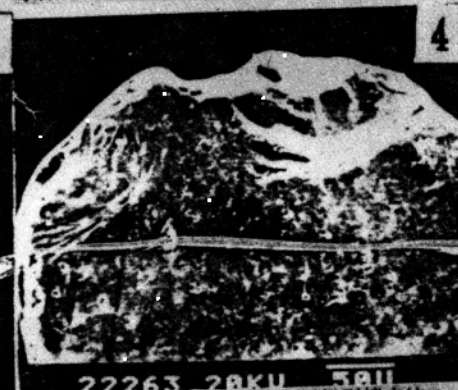
4 顶部和左上角有多个碟形坑和不规则撞击坑，表面分布很多小V形撞击坑。 水深367.2m，放大200×。
