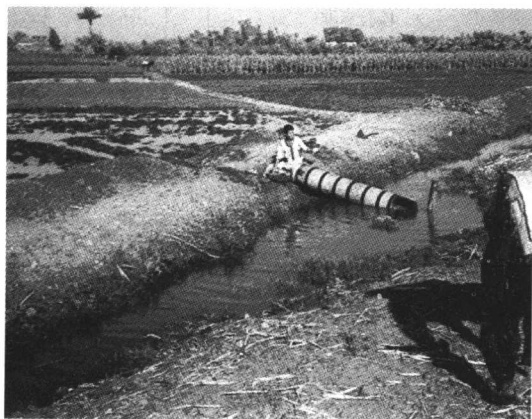
图 1-3 古希腊的阿基米德螺旋泵
