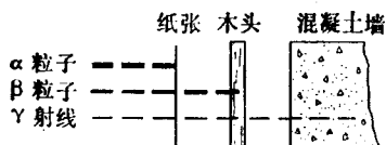
图7 α、β和γ辐射穿透力的比较
