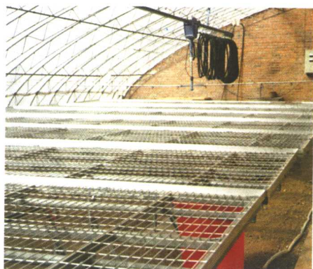
12. 育苗日光温室行走式喷水架(单轨)与滚动式育苗搁架
