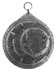
图为星盘。 阿拉伯人开发了星盘的用途，用来测量天地上空各星体的位置。
