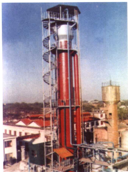
彩图17 100 米 3 气升式发酵罐
