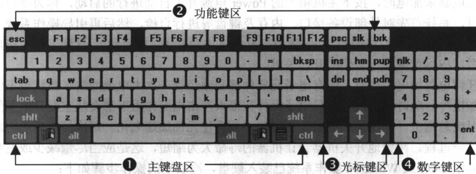
图 1-4 微机键盘结构
