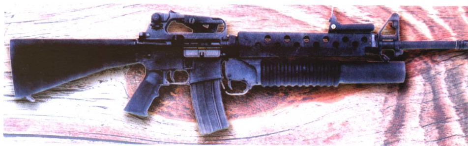
↓加挂 M203 40mm 榴弹发射器的 M16A2 突击步枪
