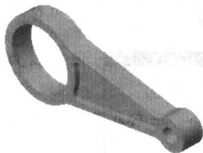
图 1-6 无边线显示实体
