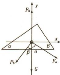
[解析] 由于各接触面是光滑的,  $a$ 、 $b$  两物体均加速下滑, 分析  $M$  受力:  $M$  自身的重力  $G$ , 地面的支持力  $F_N$ ,  $a$  对  $M$  的压力  $F_a = mg \cos \alpha$ ,  $b$  对  $M$  的压力  $F_b = mg \cos \beta$ , 如上图所示. 利用正交分解, 在竖直方向上合力为零.
