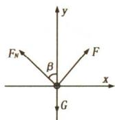
根据碗口光滑可知,  $m_1$  受到的拉力  $F$  等于  $m_2$  的重力  $m_2 g$ . 由几何知识得知  $F$  和  $F_N$  的夹角  $\beta = 30^\circ$ . 利用正交分解可得
