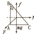
[解析] 如上图所示, 物块 ABC 受到重力、墙的支持力、摩擦力及推力四个力而平衡, 竖直方向上  $mg + F \sin \alpha = f$ .
