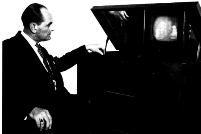
▲▲ 最早期的RCA-EMI室內接收機，使用垂直裝設的陰極射線管，經過一面鏡子和透鏡的處理把畫面投射在水平的螢幕上。倫敦北方的亞歷山卓宮（Alexandra Palace，左圖），是世界上第一個定期播放電視節目的地方。這項服務開始於一九三六年，戰爭期間曾經中斷，其後又恢復了。直到西元一九八六年之前，先天上就處於劣勢的拜爾德系統仍要參加公共傳播競爭的原因，一直是個被密切保守的秘密。
